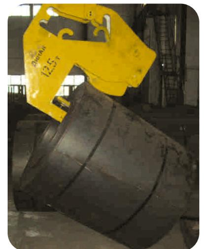
Estos aparejos permiten voltear las bobinas 90°, desde el agujero en eje horizontal al agujero en eje vertical y viceversa.
