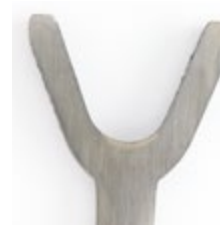
Fotografía sin retocar de una sección transversal cortada de una polea endurecida a la flama (en ácido 2-1/2 minutos)
